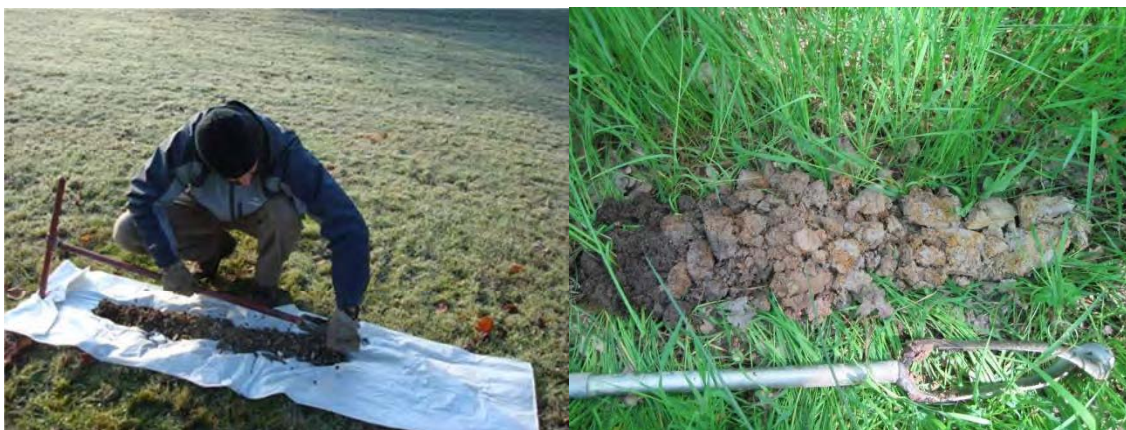
Photo 1 : Sondages à la tarière
