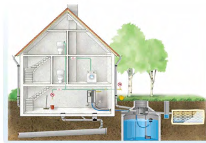
Systeme de récupération d'eau de pluie avec une injection dans un réseau spécifique pour les toilettes, la machine à laver et le jardin.
